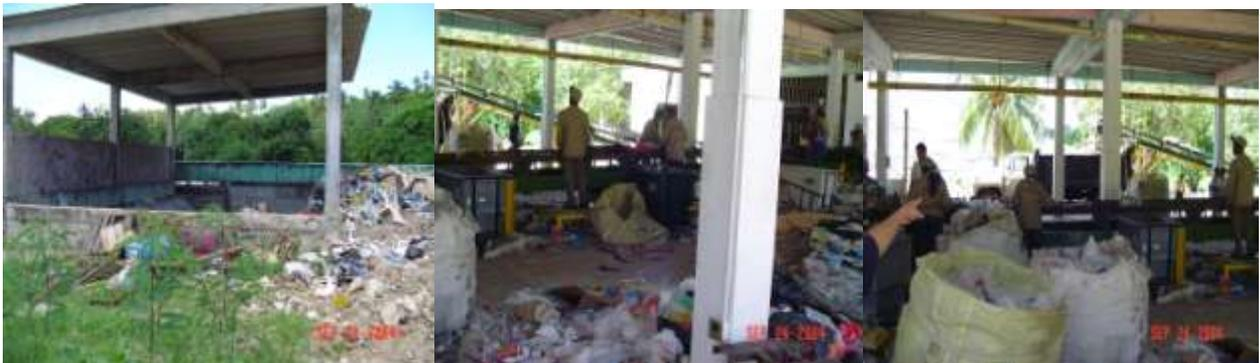
La basura que en la actualidad se viene reciclando es: cartón, papel, plásticos y vidrio. Llama poderosamente la atención como un factor positivo el hecho de que del vidrio reciclado luego de un proceso de molido, los operadores de la planta elaboran con la arena resultante bloques.
